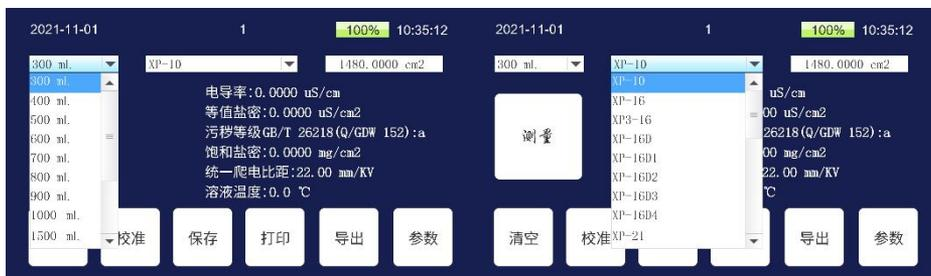
如果没有对应的型号，点击“参数”→“修改型号”或“修改总表面积”，修改完成后，点击“确定”→“保存”即可。
