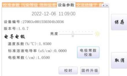
时间校正：点击“校时”，弹出时间调整波轮，可对测试时间进行校准。
