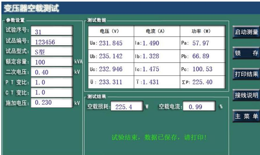
图 12 空载试验
